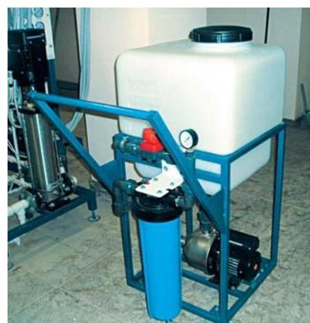
На фото представлен пример передвижной установки для химической мойки мембранны производства ООО «СВТ-Инжиниринг»
