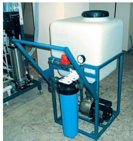
На фото представлен пример передвижной установки для химической мойки мембран производства ООО «СВТ-Инжиниринг»
